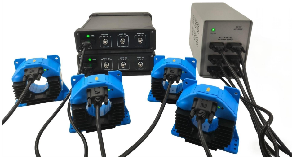
(六路高精度电压与四路高精度电流同时采集方案，电流采集需要选配专用线材)
